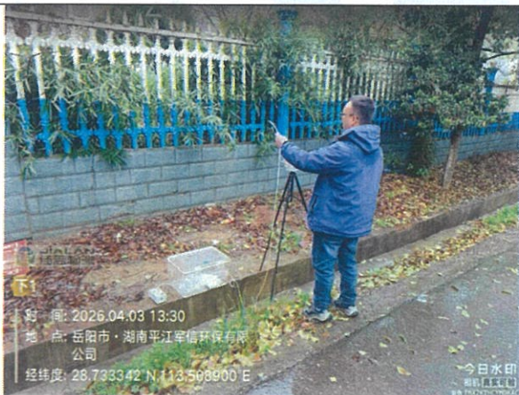
无组织废气采样（下风向）
